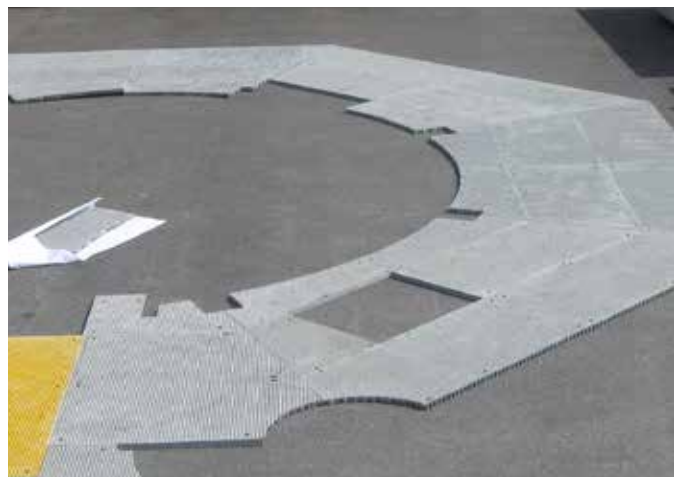
Unten rechts: Qualitätskontrolle von GFK- Gitterrosten
