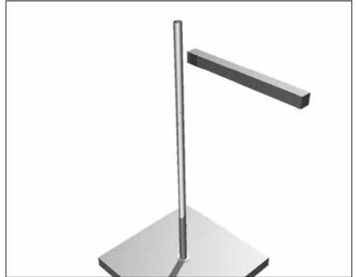
Schrauben Sie das Podest an das Standrohr und dübeln Sie danach das Podest mit geeignetem Befestigungsmaterial (nicht enthalten) an die Wand oder Balkonkante.
