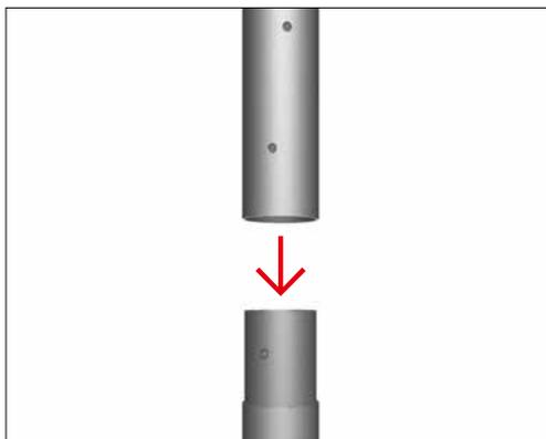
Fixieren Sie die Teile mit einer Schraube M10 x 40 mm und der passenden Unterlegscheibe.
