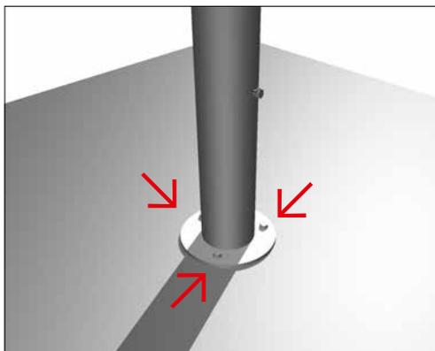
Verschrauben Sie je 2 Schrauben M 8 x 25 mm mit Vierkantmutter an der Stufe. Achtung: Schrauben so montieren, dass die Vierkantmutter außen sitzt. Die Schraube für die Vorderkante Stufe sitzt grundsätzlich in der ersten Bohrung. Die Schraube für die Hinterkante Stufe richtet sich nach dem Durchmesser der Treppe und nach der Anzahl der Stufen je Wendel. Die Werte können Sie unten in der Tabelle oder auf der Zeichnung ablesen.
