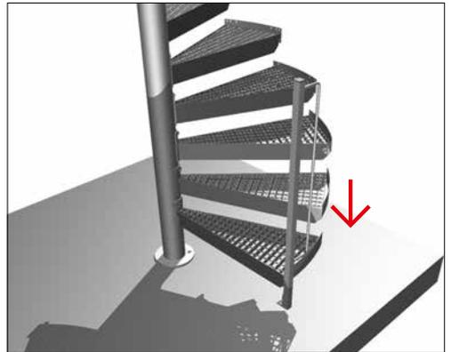
Montieren Sie danach den Fußwinkel bei der Stütze (Pos. 5). Befestigen Sie den Fußwinkel noch nicht fest auf der Bodenplatte.
