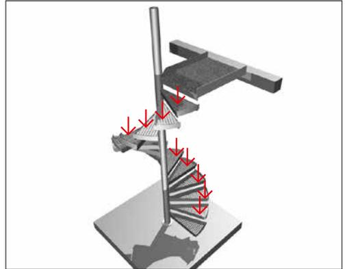
Montieren Sie die erste Geländerstütze (Pos. 5) an der Vorderkante der ersten Stufe. Die Geländerstütze muss so montiert werden, dass die Vierkantmutter im Stützenprofil sitzt.
