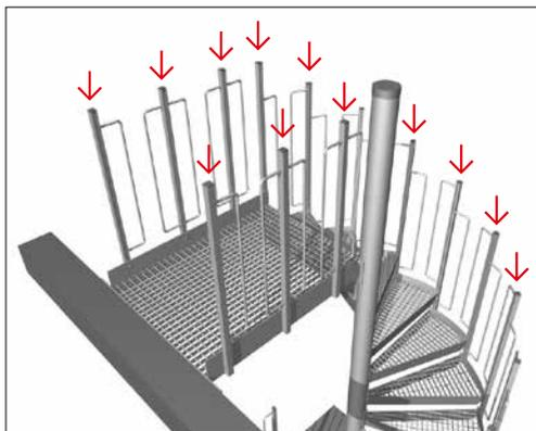
Montieren Sie den Handlauf in der gleichen Weise mit einer Schraube M 8 x 25 mm und einer Vierkantsmutter mit den Geländerstützen. Es ist darauf zu achten, dass die Handlaufteile von unten nach oben nummeriert sind, z.B. Pos. 3.1, 3.2, 3.3 usw...
