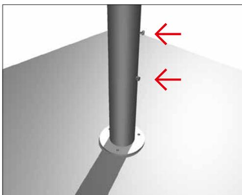
Markieren Sie den Abstand von der Wand auf den Boden und stellen Sie dann das Standrohr mit der Fußplatte auf.
