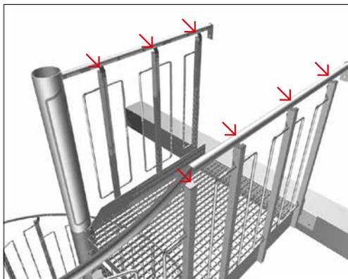
Kontrollieren Sie nun die Lage der Stufen (Steigung und Horizontallage) und ziehen Sie alle Schraubenverbindungen fest an. Beginnen Sie dabei am Podest und arbeiten dann nach unten.
