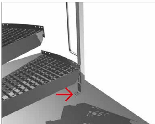
Nun montieren Sie alle weiteren Geländerstützen. Pos. 6 und Pos. 7 sind für die Stufen (Pos. 6 Geländerstütze Stufe – Stufe, Pos. 7 Geländerstütze Stufe – Podest). Pos. 8, 9 und 10 sind für das Podest. Die Unterkante der Geländerstütze muß mit der Unterkante der gebogenen Randeinfassung bündig sein. Ziehen Sie alle Schrauben fest an, damit sich bei Begehen der Spindeltreppe nichts verschieben kann.
