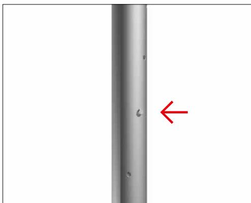
Schrauben Sie alle Schrauben M10 x 40 mm mit Unterlegscheibe in das Standrohr und lassen Sie bei jeder Schraube ca. 20 mm Luft, damit Sie später die Stufen einhängen können.
