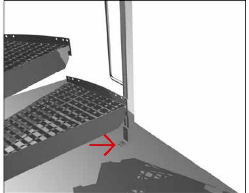
Ziehen Sie die Schrauben an den Geländerstützen fest an.
