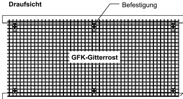
**Befestigung der GFR-Gitterroste**
